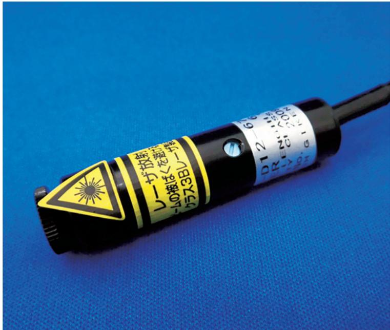
レーザーポインターMLXSタイプ(スポット光)は、各種半導体レーザー素子の特性を考慮し、最適な状態で安定発振するように設計された製品です。ボールガラスレンズの採用により近距離での小スポット光照射に適しています。
