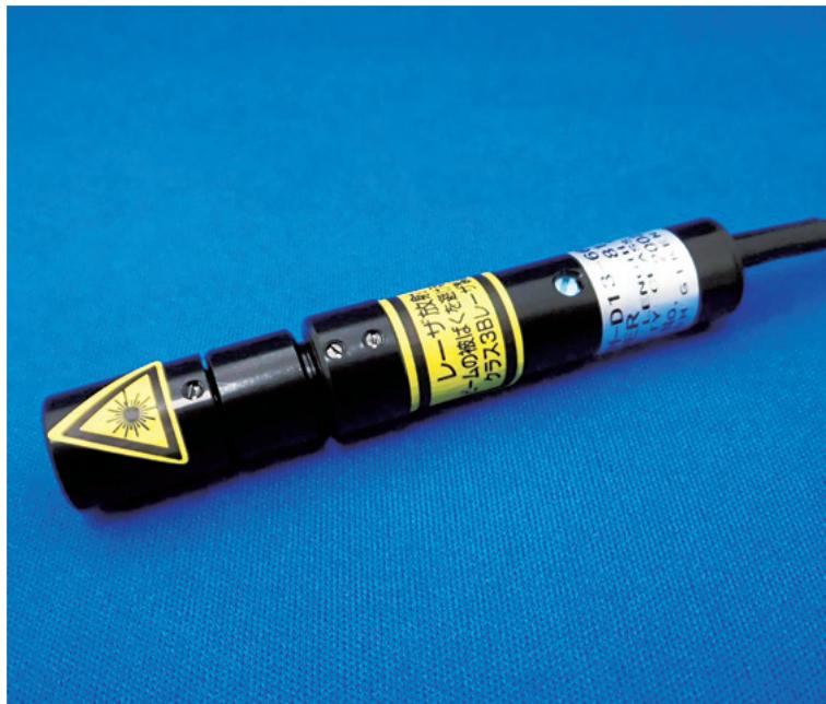
極細ラインMLXHシリーズは、近距離・高精度にて $10\mu\text{m}$ 幅のライン(スリット)光が得られます。精密な位置合わせや画像処理に最適です。ご注文時にご希望の焦点距離に最適なレンズを選択して製造します。
